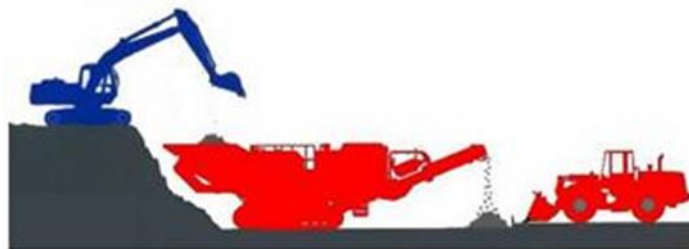
Рисунок 3.43 - Дробление с помощью дробильной установки
